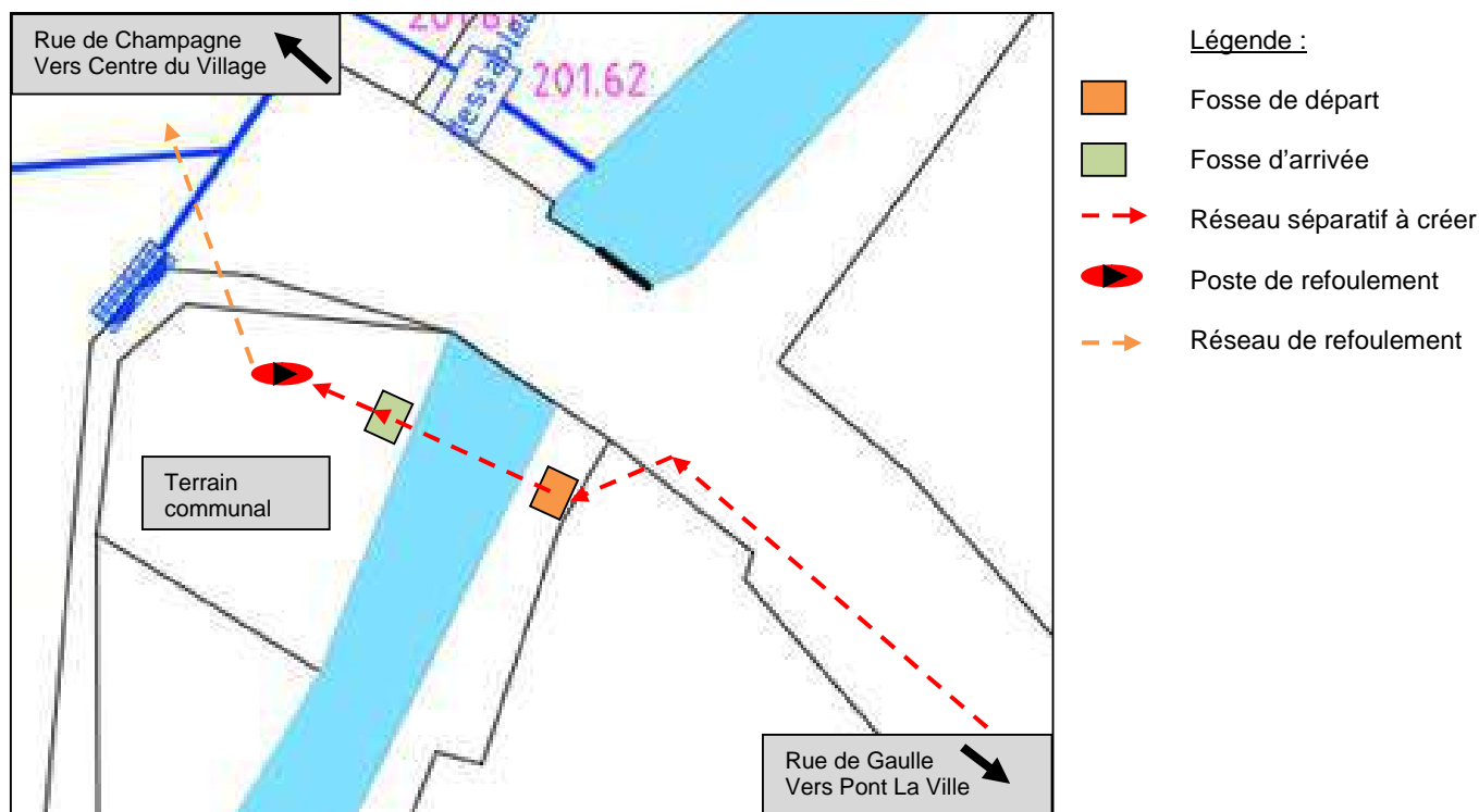
Localisation des 2 fosses en cas de fonçage (solution 2)
